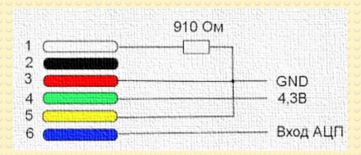
Каждый из 4-х портов для датчиков может работать с 3-мя типами протоколов: аналоговый, цифровой I2C, цифровой UART.
