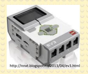
При разработке робота на контролере № № № № № № На необходимо использовать много датчиков контакта, но возможности контролера ограничены и к одному порту EV3 можно подключить только 1 датчик контакта, либо использовать существующий мультиплексор на 4 датчика стоимостью 2700 руб. Также наличие самих датчиков контакта ограничено и их габаритные размеры не позволяют разместить достаточное их количество на роботе.
